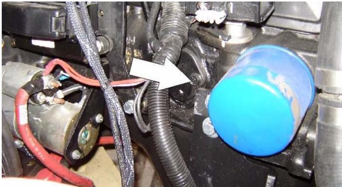
Schmierpunkt(e) - Einfüllverschluss/Aufschraubeinsatz
