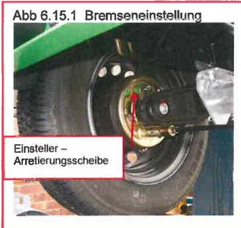
Abb 6.15.2 Einstellung der Bremse
